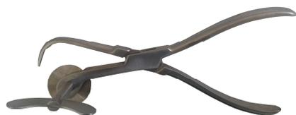
Pince équipée d'une lame circulaire pour couper les bagues jusqu'à 2,5 mm d'épaisseur.
